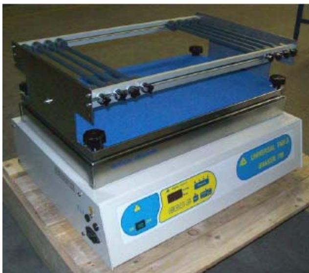
Vertical stirrer ES-709/V with universal basket suitable for holding and fixing beakers and flasks of different sizes / Agitateur vertical ES-709/V avec panier de type universel adapté à loger et fixer bêchers et flacons de tailles différentes.
